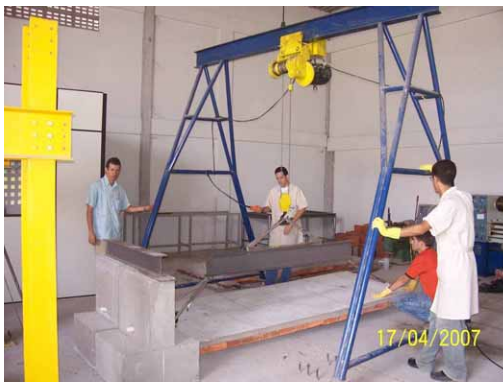
Figura 47 – Transporte da laje até o local do ensaio
