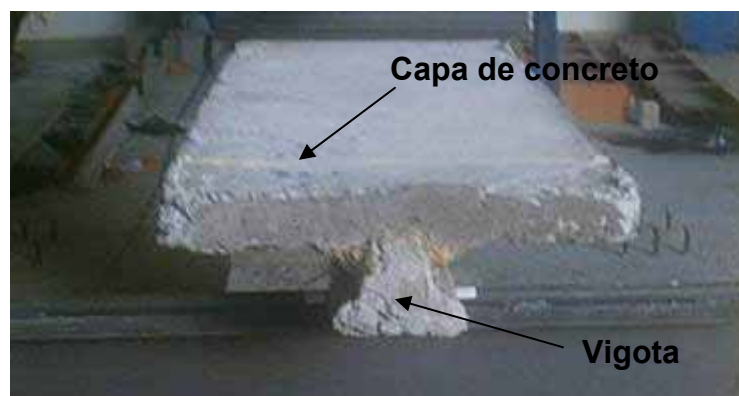
Figura 31 – Seção T após a moldagem antes do ensaio
