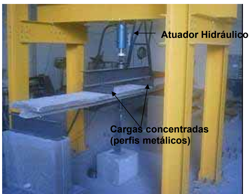
Figura 50 – Esquema de carregamento das vigas T
