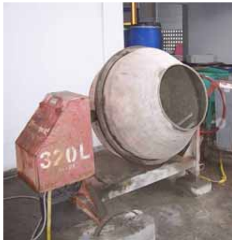
Figura 39 - Betoneira utilizada para a fabricação dos concretos
