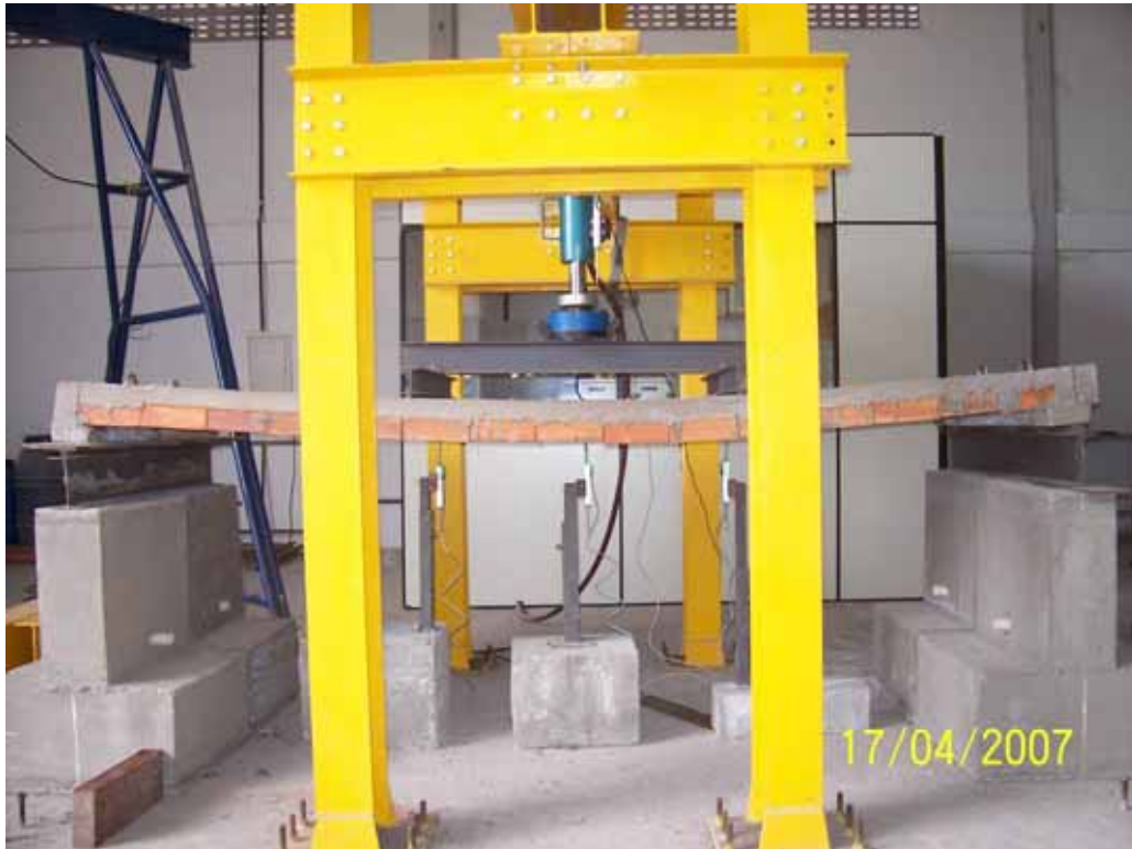
Figura 59 – Laje com deflexão excessiva
