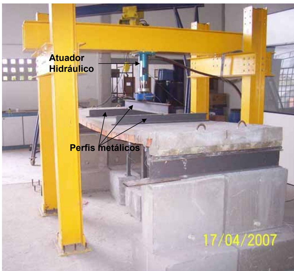
Figura 51 – Esquema de carregamento das lajes
