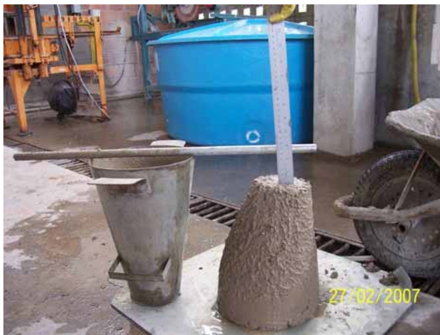
Figura 41 – Ensaio de abatimento de cone
