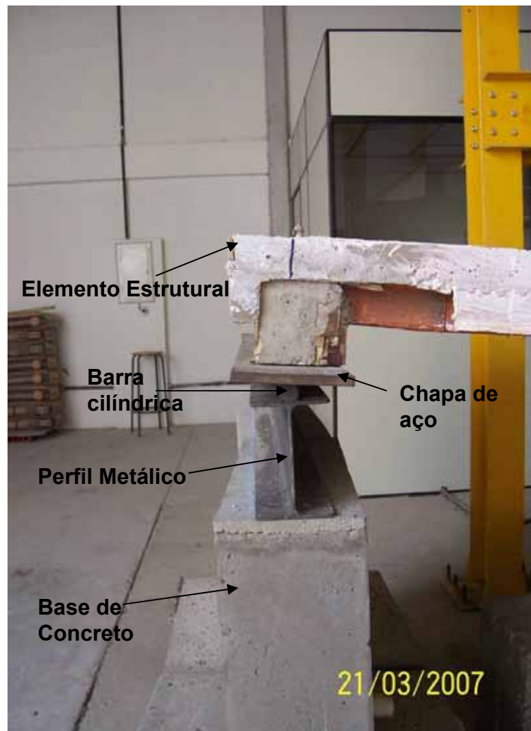
Figura 53 – Rotação do elemento estrutural no apoio
