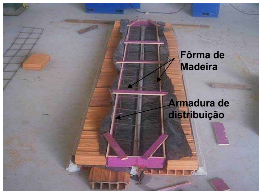
Figura 32 – Fôrma de madeira utilizada para a moldagem da viga T
