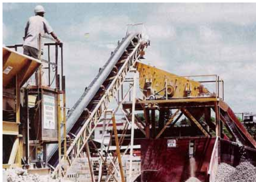
Figura 4 - Usina de reciclagem no canteiro da obra do condomínio Villagio Maia (CAPELLO-2006)
