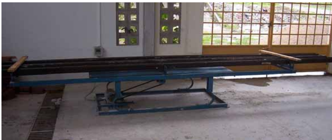
Figura 42 – Mesa vibratória utilizada para adensamento das vigotas
